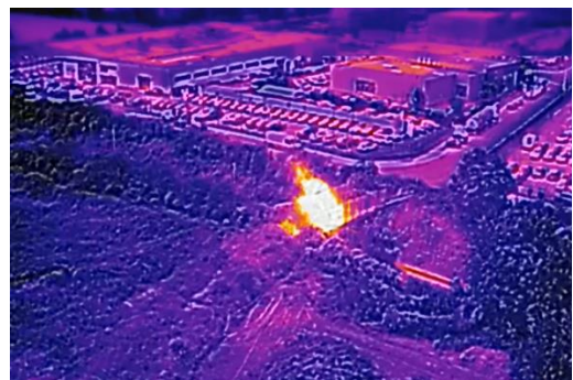
Localisation de la fuite de gaz enflammée à l'aide de l'imagerie thermique © SDIS 95
